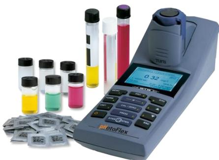
Viele Gesundheitsämter und Wasserversorger sowie Servicelabors haben deshalb heute gleich mehrere pHotoFlex® Turb für die mobile Überwachung von Trinkwasseranlagen, Brunnen, Gemeindeschwimmbäder oder Thermen in Betrieb. Dieses portable Photometer verfügt über alle erforderlichen Programme für eine photometrische Wasseruntersuchung bis in kleinste Messbereiche durch das flexible Küvetten-system von 16- und 28-mm-Küvetten sowie die normgerechte Färbungsmessung bei 436 nm in (Trink)wasser.
